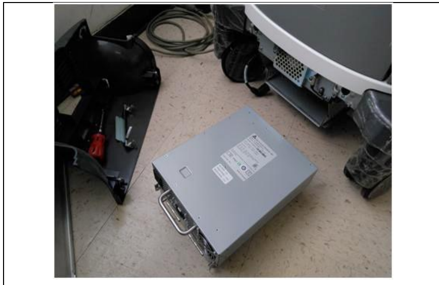
Figura 7.6.1 Reemplazo de la fuente de alimentación
