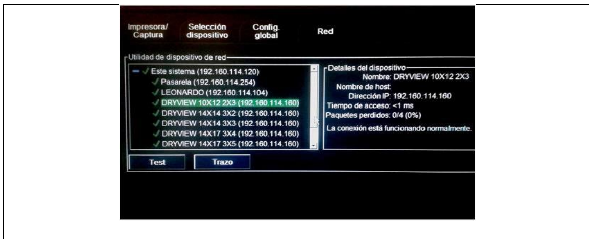
Figura 7.5.5 Comprobación de conexión con servidor DICOM e impresoras
