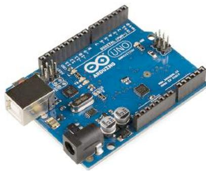
Imagen 17. Placa Arduino Modelo UNO<sup>83</sup>
