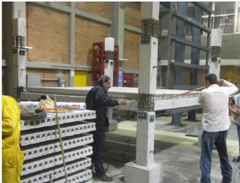
Figura 4.1. Conexiones trabe- columna (Escobar et al., 2015)
