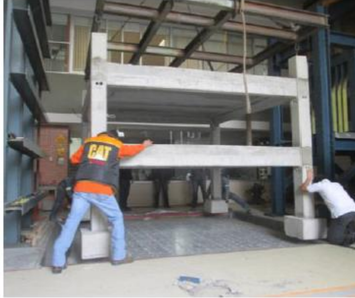
Figura 4.3. Pasos para montar el edificio prefabricado utilizado (Escobar et al., 2015)
