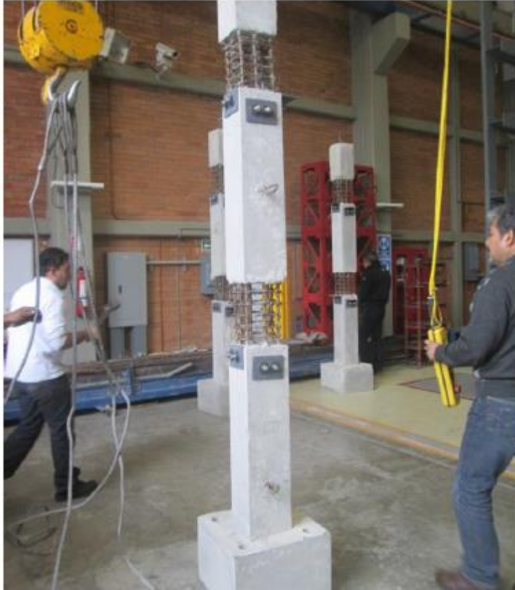
Figura 4.2. Conexión columna- columna (Escobar et al., 2015)
