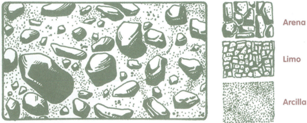
Figura 2.2. Esquema del tamaño de las partículas que componen el suelo.
