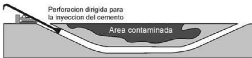
Figura 4.14. Inyección de solidificantes.
