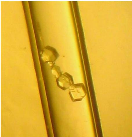
**Figura 20.** Campo al microscopio (40X) de un capilar donde crecieron cristales del análogo Glargina, a temperatura ambiente. Se observa la presencia de monocristales creciendo sobre una fibra contaminante.
