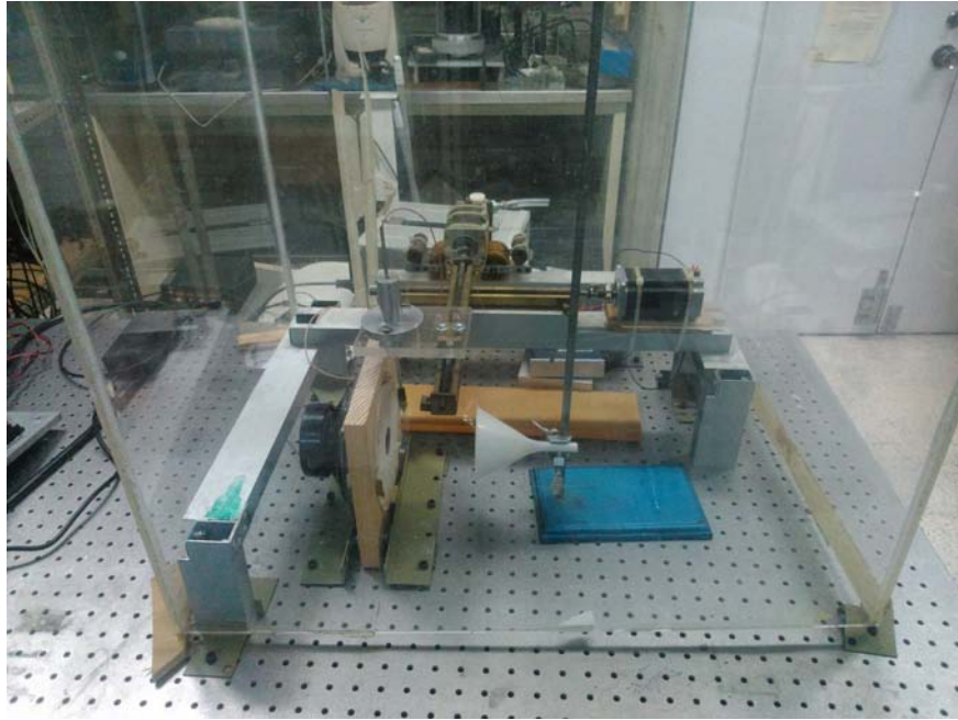
Figura 3.11: Sistema de posicionamiento X-Y, bocina y cono dentro de la caja de acrílico
