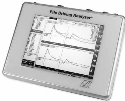
Figura 4-8 Hardware de adquisición de datos PDA-8G. (PDI)
