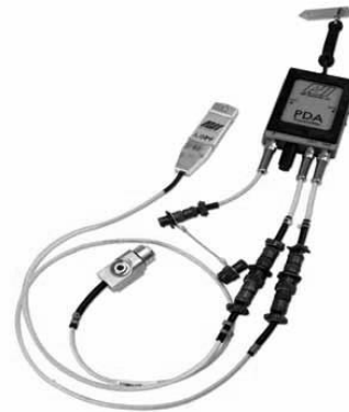
Figura 4-9 Transductores de fuerza y aceleración PDA-8G (PDI)
