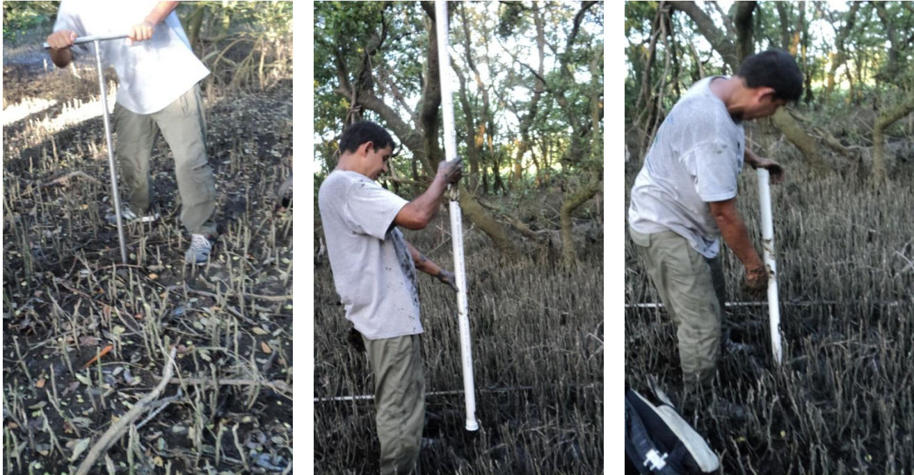
Figura 11. Instalación de piezómetros.
