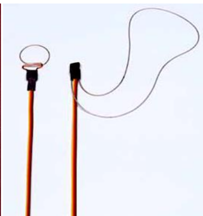
Ilustración 8. Pletismografía con extensómetro de mercurio utilizada para la obtención de registros de volumen de pulso arterial en las extremidades inferiores y el índice dedo/brazo (IDB) (Imagen superior). Pletismógrafo con extensómetro de mercurio portátil (Imagen inferior izquierda). Aros de mercurio recubiertos de silastic, utilizados en la plethysmografía con extensómetro de mercurio, el pequeño para el dedo del pie y el grande para la circunferencia de la pierna (Imagen inferior derecha). Imagen superior obtenida del sitio web: studyblue.com, netterimages.com y de Elsevier, Inc. Imagen inferior izquierda obtenida del sitio web: ebay.com. Imagen inferior derecha obtenida del sitio web: newmoa.org y de D.E. Hokanson, Inc.
