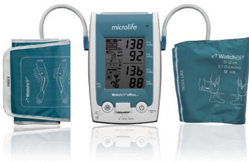
Ilustración 5 .Dispositivo oscilométrico automatizado utilizado para la obtención del índice tobillo/brazo (ITB). Cuenta con un manguito de compresión para el brazo y otro para el tobillo. Prescinde de utilizar un ultrasonido doppler o alguna técnica pletismográfica. Imagen obtenida del sitio web: primarycaresupplies.co.uk y de microlife.
