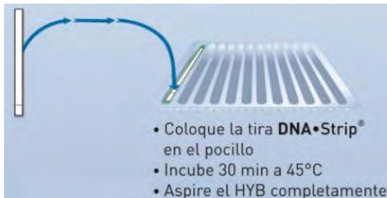
Figura 10. Paso de la Hibridación donde se agrega la tira DNA•STRIP®, se incuba y aspira la solución HYB
