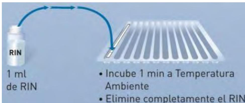
Figura 14. Paso de la hibridación donde se agrega la solución RIN
