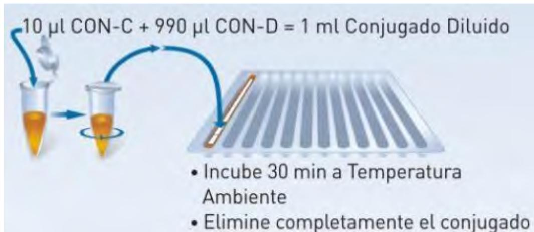
Figura 15. Paso de la hibridación donde se agrega el concentrado diluido
