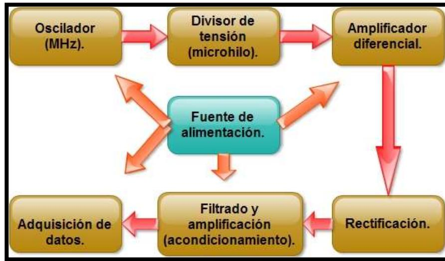
Figura 2.6 Diagrama a bloques de un sensor de MI.
