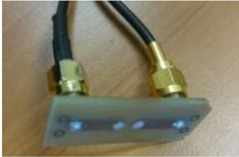
Figura 2.2 Portamuestras construido para el microhilo amorfo.
