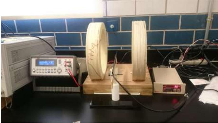
Figura 2.14 Montaje experimental para mapeo con la punta Hall.
