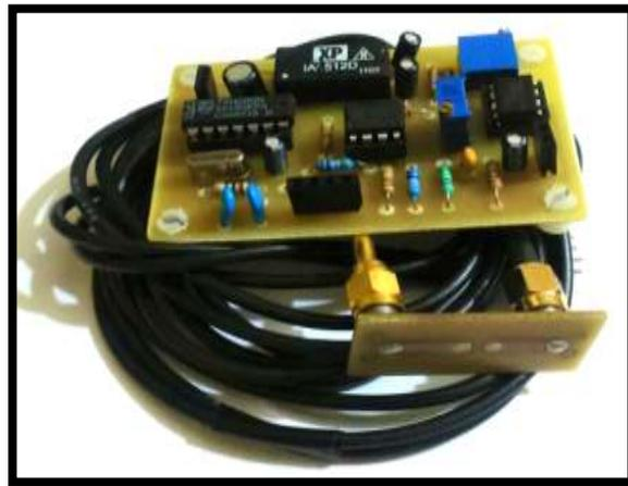
Figura 2.10 Fotografía del circuito de acondicionamiento terminado y el transductor formado por el portamuestras y el microhilo amorfo.
