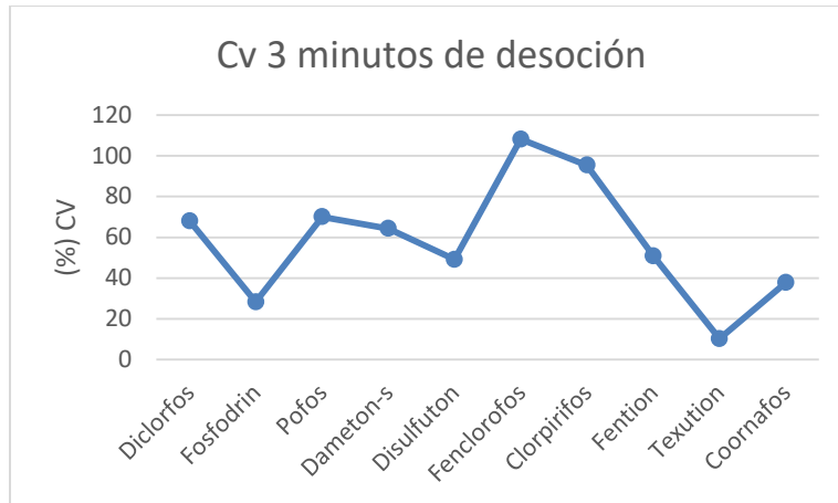
Figura 29. Coeficiente de variación para las microextracciones por SPME a 3min de desorción.
