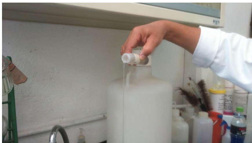
Figura 84. Después del centrifugado se vierte el agua destilada para continuar lavando la muestra (fotografía de Laura Romero)
