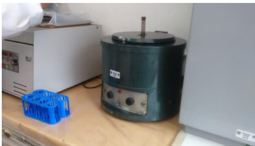
Figura 83. Proceso de centrifugado para la limpieza de las muestras (fotografía de Laura Romero)
