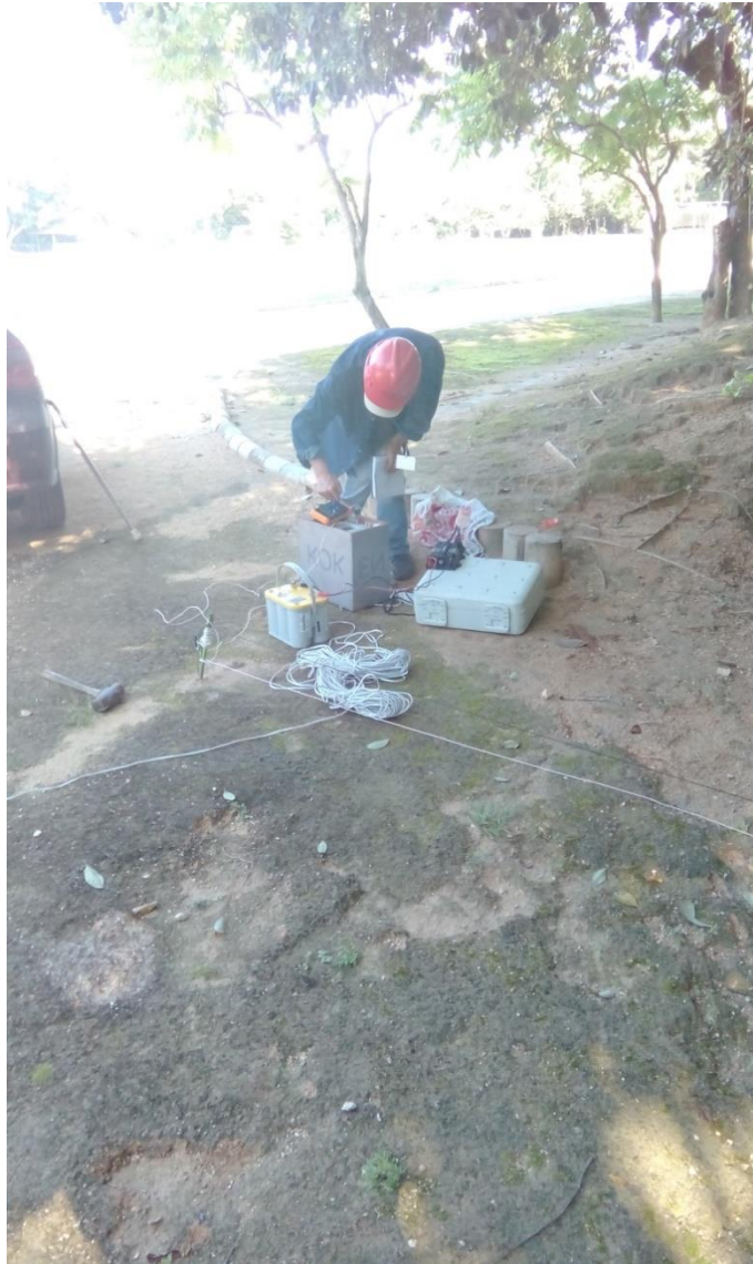
Toma de datos con el equipo de resistividad
