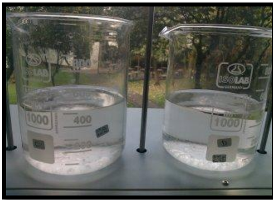
Figura 14. Agua clarificada (coagulada-floculada)
