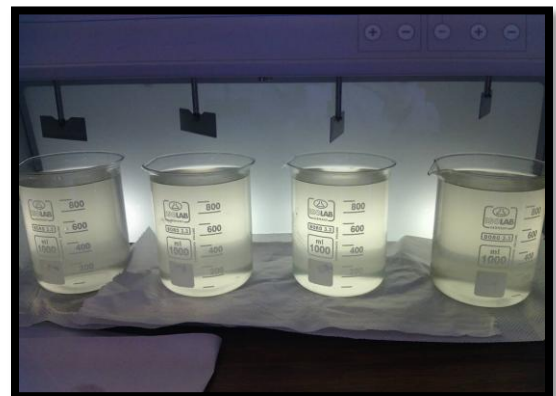
Figura 11. Aplicación del floculante (agitación lenta)
