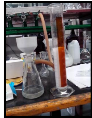
Figura 15. Sistema de filtración
