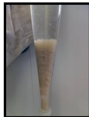
Figura 13. Remoción de lodos por decantación
