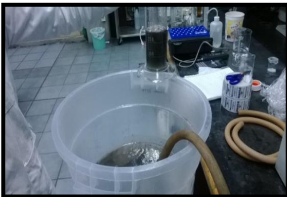
Figura 6. Sistema de flotación por aireación
