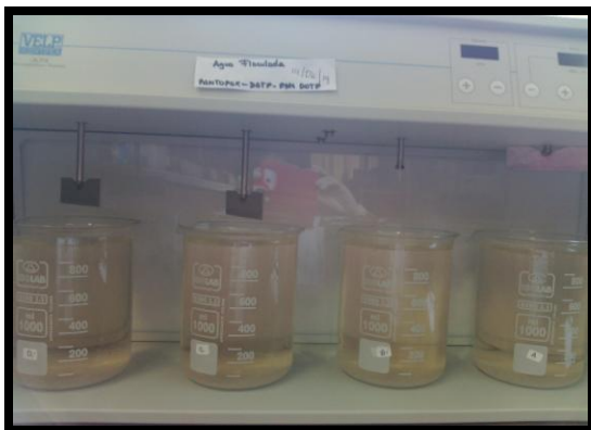
Figura 10. Aplicación del coagulante (agitación rápida)
