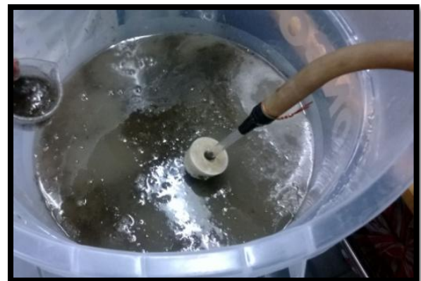
Figura 7. Inyección de aire y formación de finas burbujas
