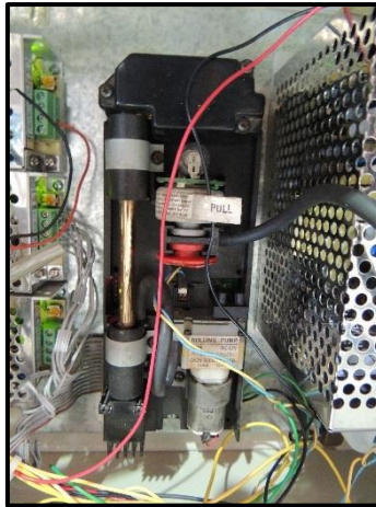
Ilustración 3.4. Banca de cinco gases Andros6600.
