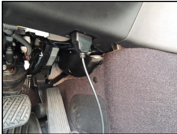
Ilustración 1.14. Ubicación del conector OBD II en un Infiniti Q50.
