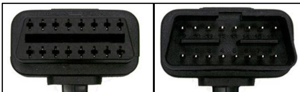
Ilustración 1.12. Conector OBD II hembra-macho.
