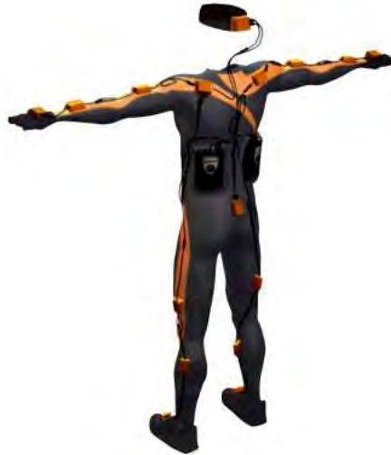
Figura 4. Traje desarrollado por Xsens, consta de 17 sensores y es alimentado por 8 pilas AA (Roetenberg, Luinge, and Slycke 2015).
