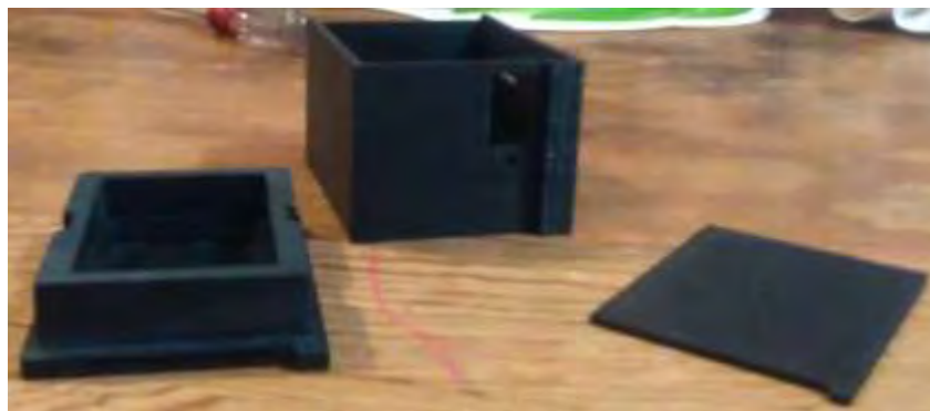
Figura 35. Armazón para la tarjeta de control y el sistema de alimentación, diseñado en NX 8.5 y fabricado en el MADiT del CCADET de la UNAM.
