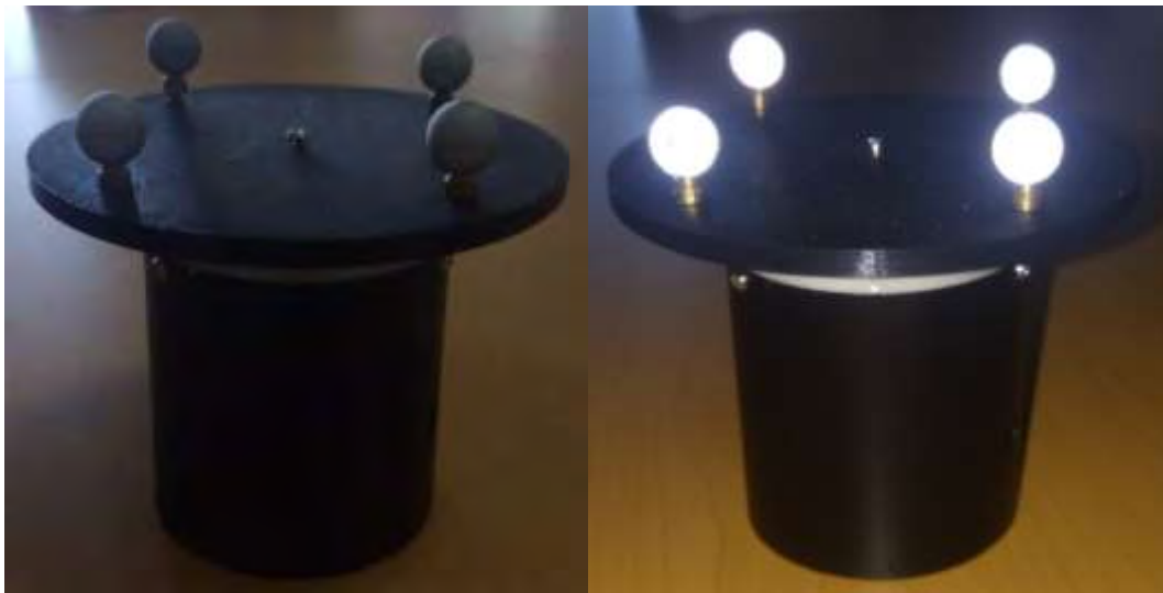
Figura 39. Sistema de calibración para los giróscopos, diseñado en NX 8.5 y fabricado con ayuda del MADiT de la UNAM.
