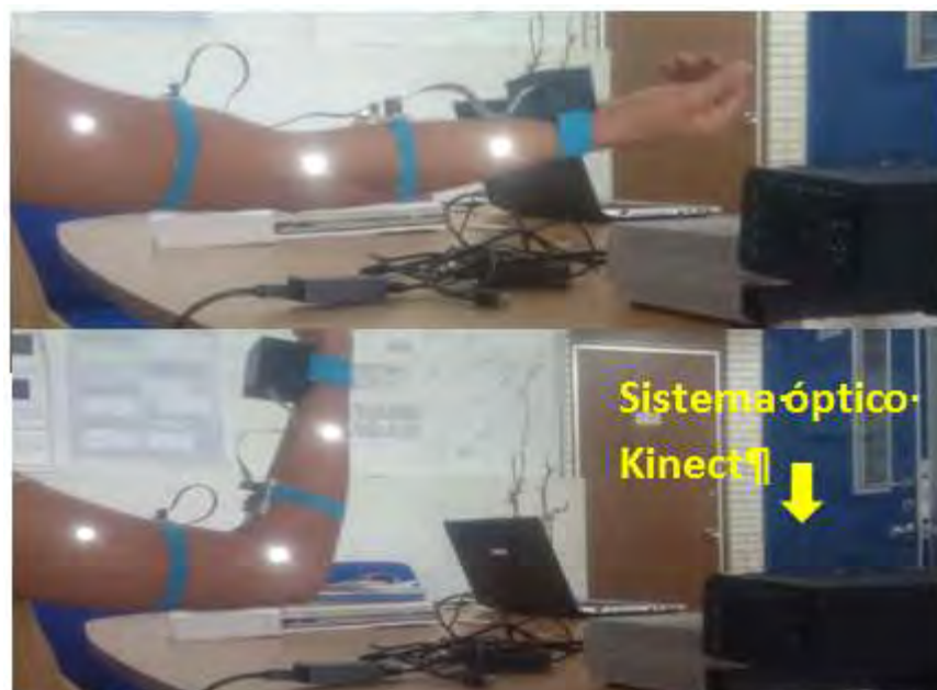
Figura 53. Movimientos de extensión y flexión hasta los 90° frente al sistema óptico Kinect.
