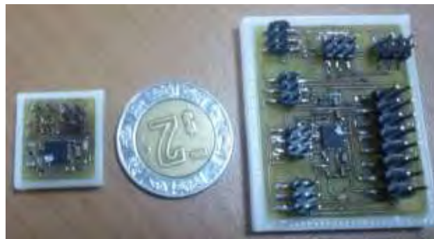
Figura 46. Tarjetas diseñadas para hacer las pruebas de la estimación de la orientación y validación del sistema, con una referencia de su tamaño.
