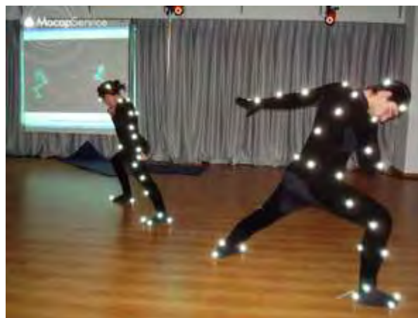
Figura 2. Sistema óptico de seguimiento humano utilizando indicadores.
