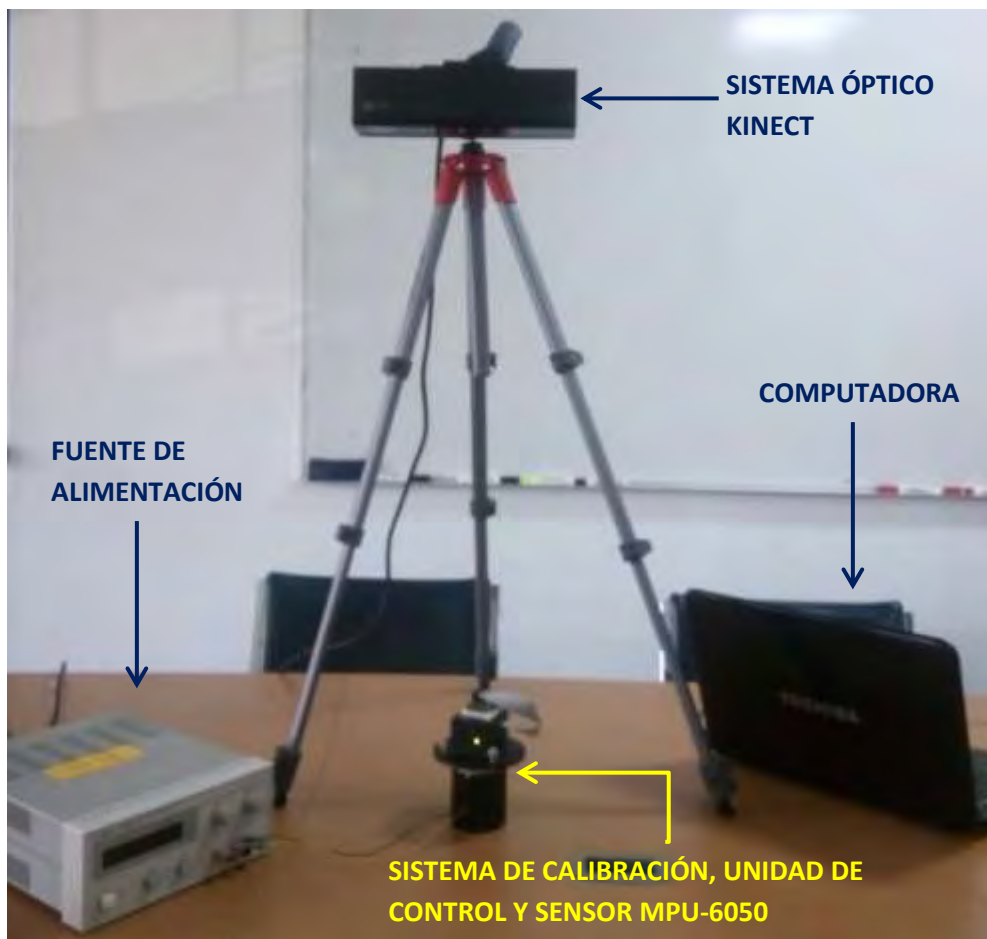
Figura 42. Arreglo para la calibración de los valores de referencia de los giróscopos.
