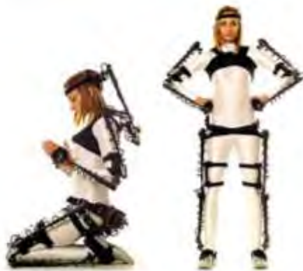
Figura 1. Traje electromecánico para seguimiento humano.
