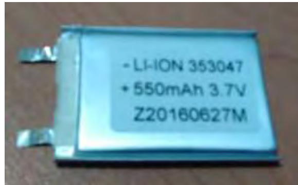
Figura 34. Batería de iones de Litio utilizada para alimentar el sistema.
