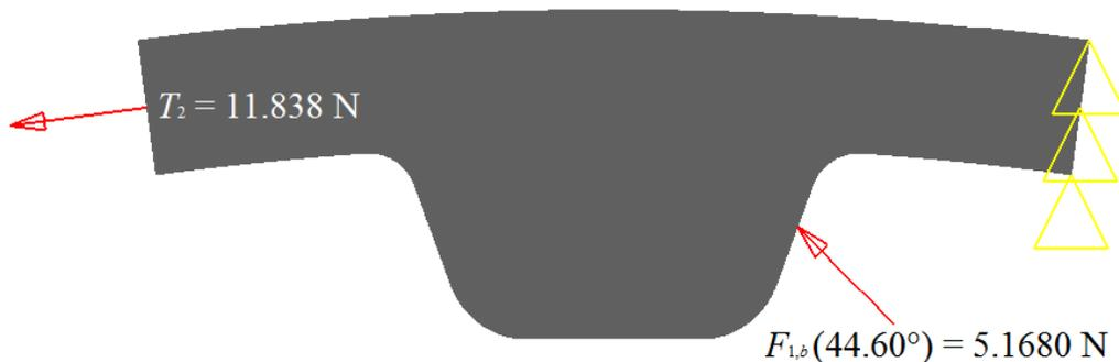
Figura 3.5. (a) Cargas aplicadas en el diente L cuando  $\psi = 44.60^\circ$ .
