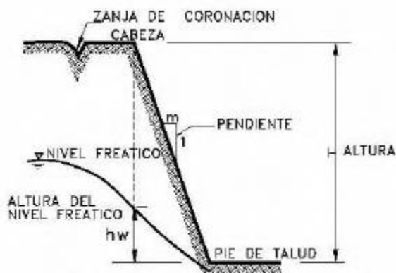
Figura 4.1 Talud en corte o relleno (Suarez, 1998)
