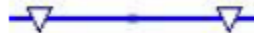
Figura 5.5 Representación de la superficie potencial de flujo (Potential Seepage Face) en Seep/W
