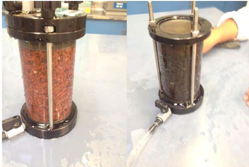
Figura 4-13. Columnas empacadas para las pruebas de permeabilidad para los materiales de empaque.
