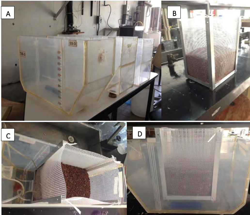
Figura 3-7. Celdas de acrílico utilizados para rellenar con material, que simula el acuífero y la BRP. A) Celda de acrílico. B) Barrera Reactiva Permeable. C) y D) BRP con difusores de oxígeno.
