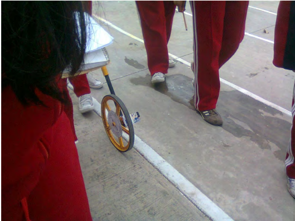
IMAGEN 3. Medición de un lado del predio sobre el piso en una recta paralela a la pared a fin de librar construcciones sobre el lado del predio.
