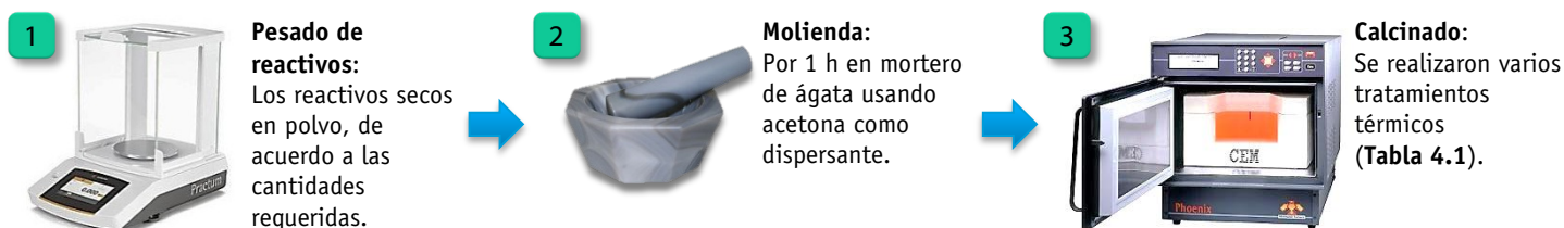
Figura 4.1: Esquemización del proceso de síntesis por reacción en estado sólido.
