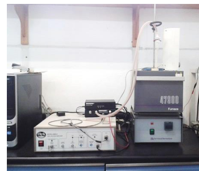
Figura 4.5: Histerímetro Radiant® y fuente (HV) Trek® acoplados a mufla Thermolyne® para las determinaciones de ciclos ferroeléctricos a diferentes temperaturas.
