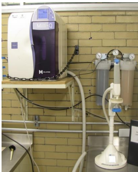
Figura 3.6 Sistema para el tratamiento del agua
