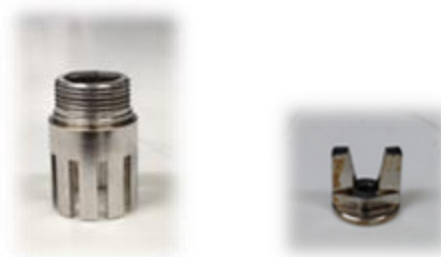
Figura 3.5 Elementos de dispersión del mezclador IKA T25.
