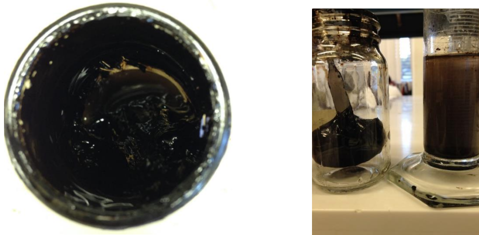
Figura 3.15 Emulsión débil en reposo y medición del agua separada.
