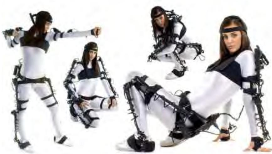
*Figura 55.- Sistema electromecánico Gypsy 6 de la empresa MetaMotion [78].*
