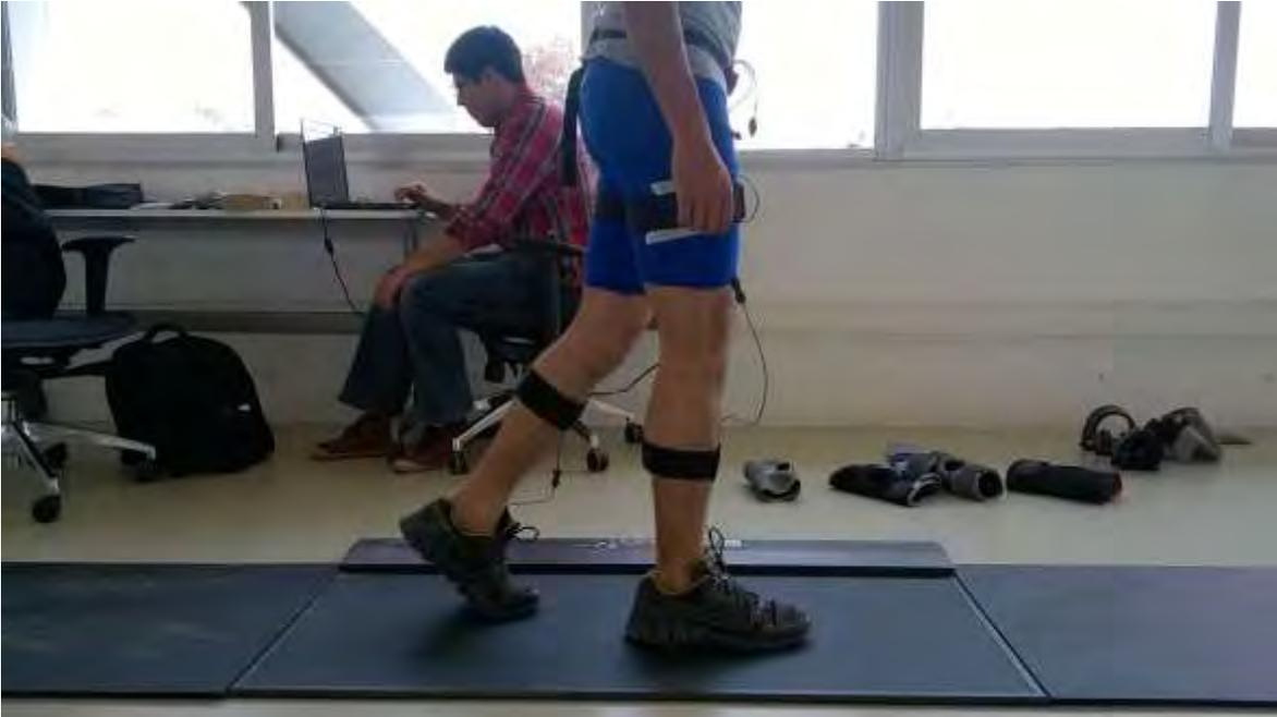
Posteriormente, se coloca una órtesis de rodilla y se realiza la captura del ciclo de marcha con la plataforma baropodométrica.
