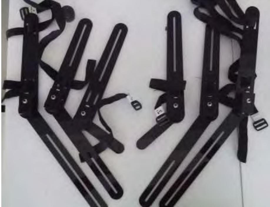
Sobre los centros de rotación identificados previamente por el módulo de antropometrías, se coloca el centro de rotación de los goniómetros. El brazo fijo se coloca de tal manera que siga el eje anatómico del elemento proximal y el brazo móvil el eje anatómico del elemento distal. Lo anterior nos permite reconstruir la cadena cinemática de miembro inferior. Con dicha cadena, se pretende validar la información obtenida de las IMUs a emplear en el siguiente módulo.
