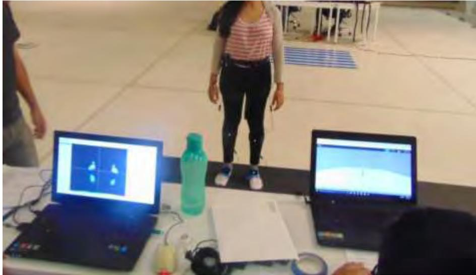
Análisis de Marcha.- Con los sensores inerciales colocados, se le solicita a la persona que camine sobre la plataforma. Se dejan pasar 5 eventos de marcha y se graban 5 eventos completos de un ciclo de marcha de manera seguida del movimiento de la persona. La plataforma baropodométrica registra la información dinámica de la persona para los mismos 5 eventos.
