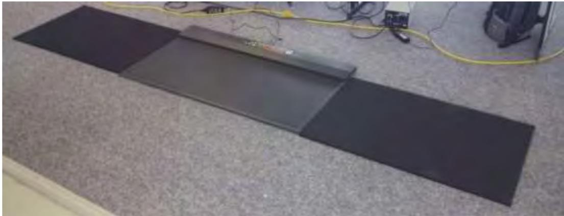
La plataforma nos permite determinar el centro de presiones del pie y obtener la magnitud y distribución de la componente vertical del vector de reacción del piso durante un análisis postural o de marcha.
