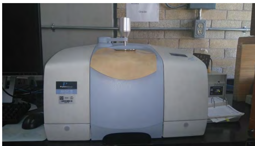
Figura 43. Espectrómetro infrarrojo Perkin Elmer 100
