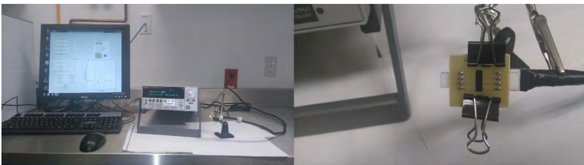
Figura 68. Montaje experimental para las pruebas de conductividad
