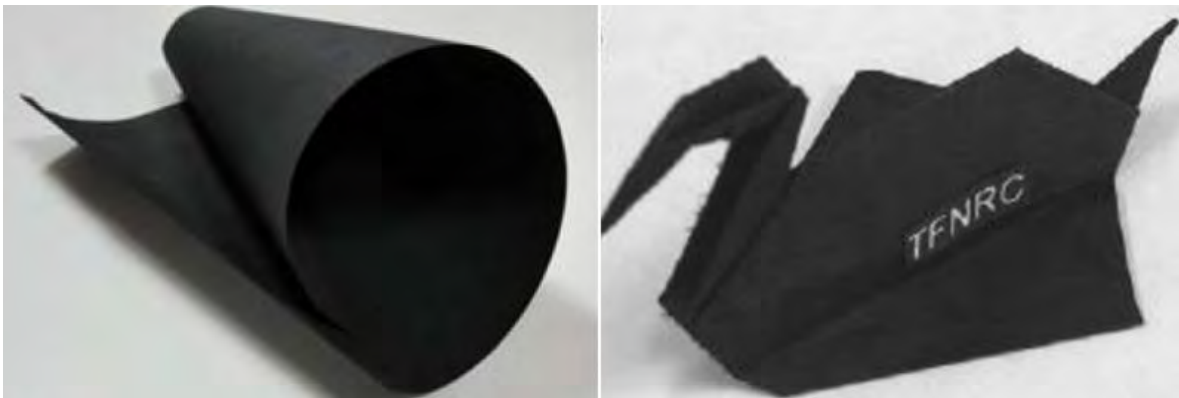
Figura 26. Izquierda: Película de buckypaper MWCNT's fabricado por NanoTechLabs.Inc. Derecha: un cisne de origami hecho de Buclypaper de MWCNT's alineados por el método de síntesis compresión en dominio auxiliada por CVD.
