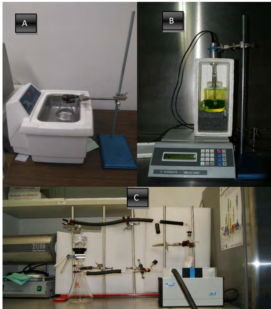
Figura 38. Síntesis de Buckypaper. A) Izquierda agitación en baño ultrasónico. B) En medio agitación en punta ultrasónica. Abajo C) sistema de filtración de nanotubos de carbono.
