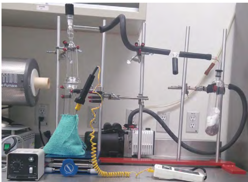
Figura 41. Sistema para desgasificación
