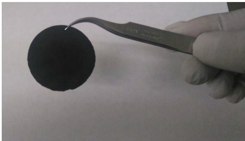
Figura 39. Buckypaper de diámetro de 3.45 cm obtenido por el método de filtración al vacío.
