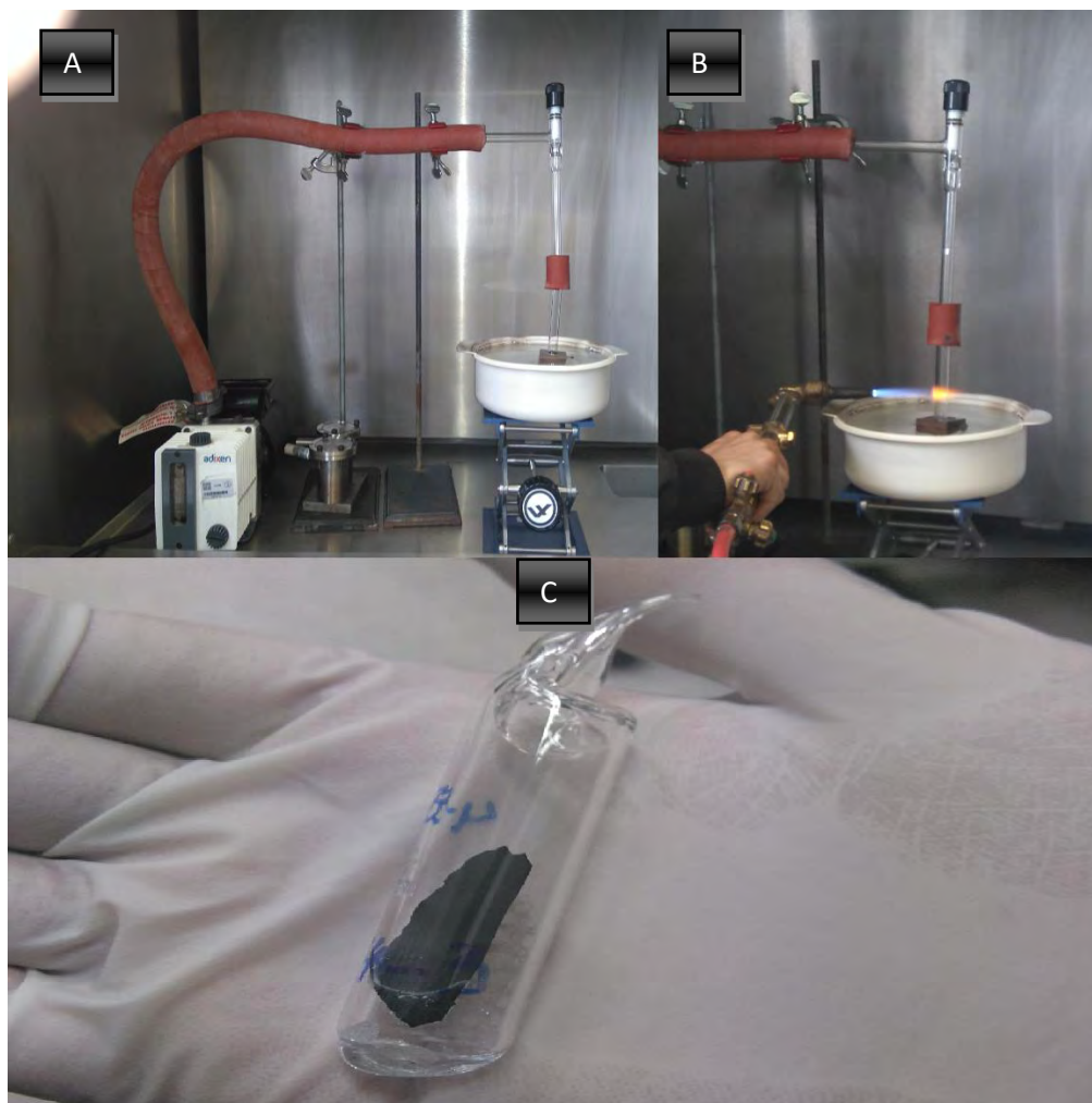
Figura 40. Proceso de sellado de las ampolletas. A) montaje del sistema. B) sellado del tubo. C) ampolleta obtenida.
