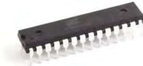
ILUSTRACIÓN 2.6 ENCAPSULADO DIP ATMEGA 328
