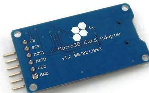
ILUSTRACIÓN 2.22 TERMINALES DE CONEXIÓN MÓDULO MICROSD
