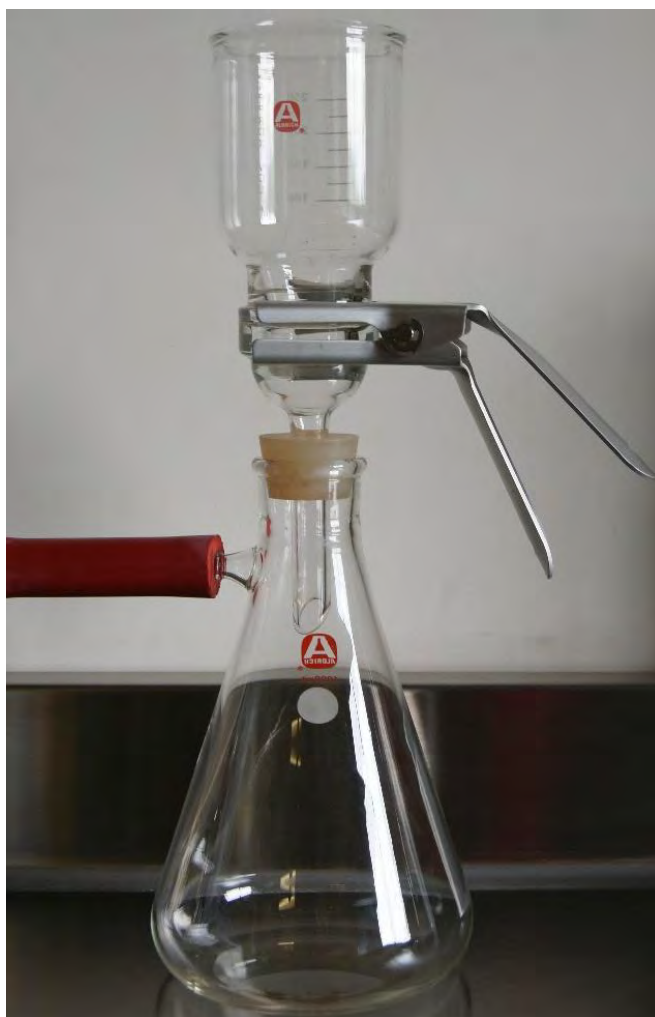
Figura 16. Sistema de filtración del papel GO. La disolución de óxido de grafeno se filtra al vacío a través de una membrana de acetato de celulosa soportada sobre un embudo plano de vidrio esmerilado.
