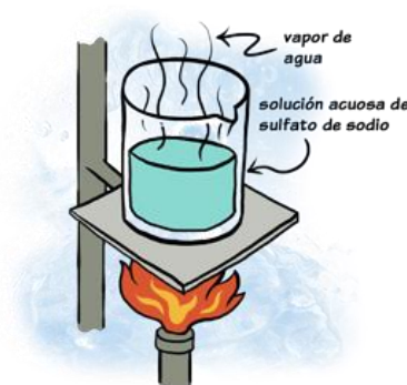
Figura III.2.14.iv.b. Separación de mezclas por evaporación.
