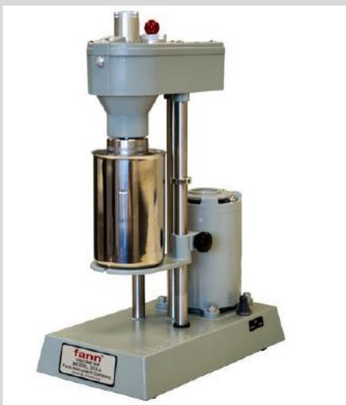
Figura III.2.11.iv.c. Viscosímetro de flujo Couette, Fann 35.
