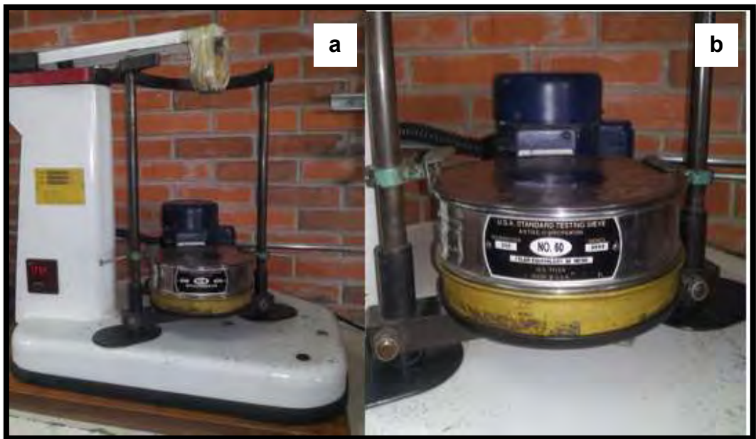
Figura 2.2 Tamizado de la harina de amaranto a) Rot tap, b) Tamiz 60 serie USA
