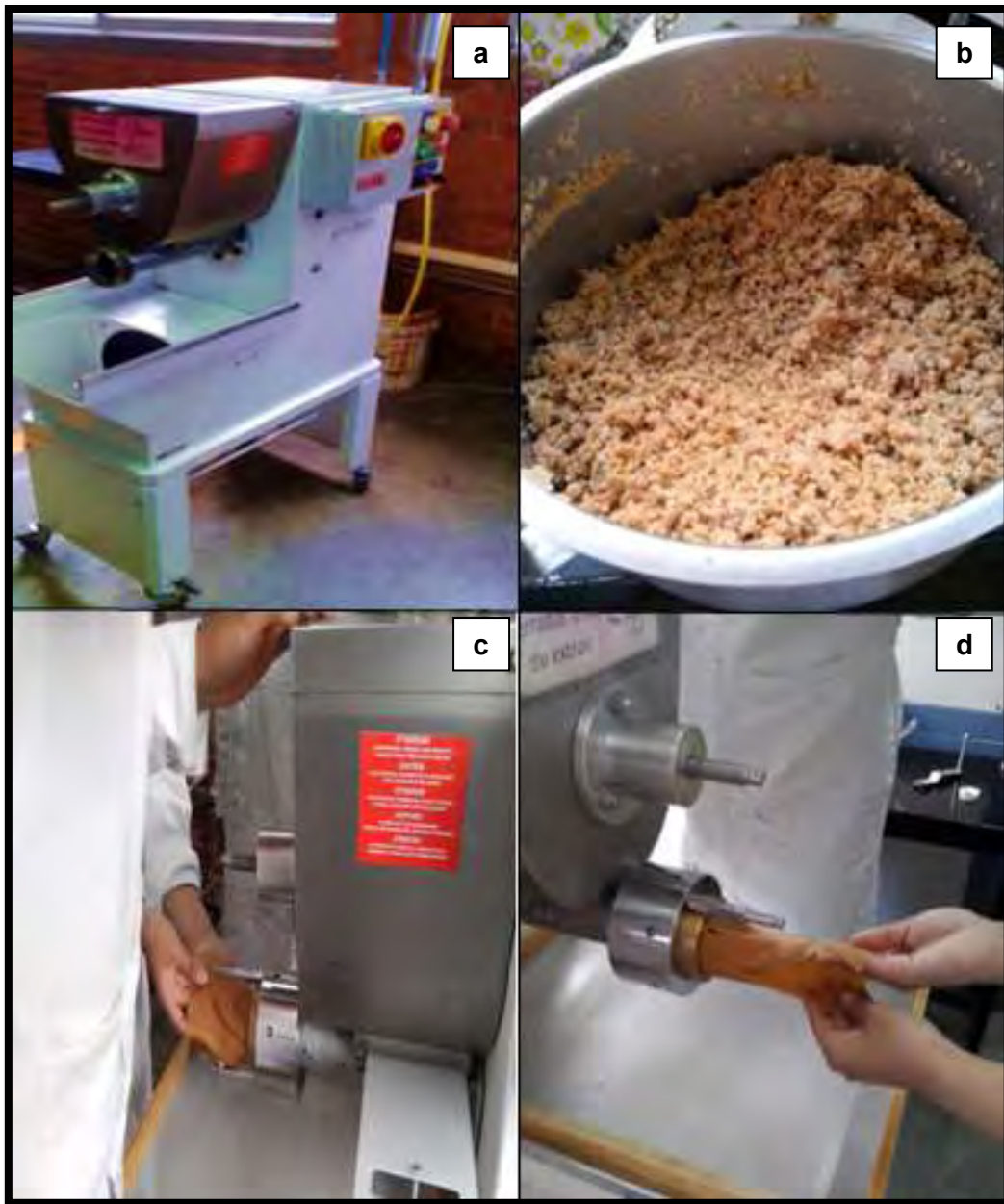
Figura 2.4 Extrusión de la botana, a) extrusor en frío, b) formulación de harina mezclada e hidratada c) extrusión de la muestra d) Placas y tiras
