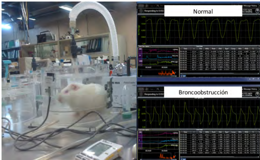
Figura 7. Pletismógrafo Barométrico para evaluar la función pulmonar.
