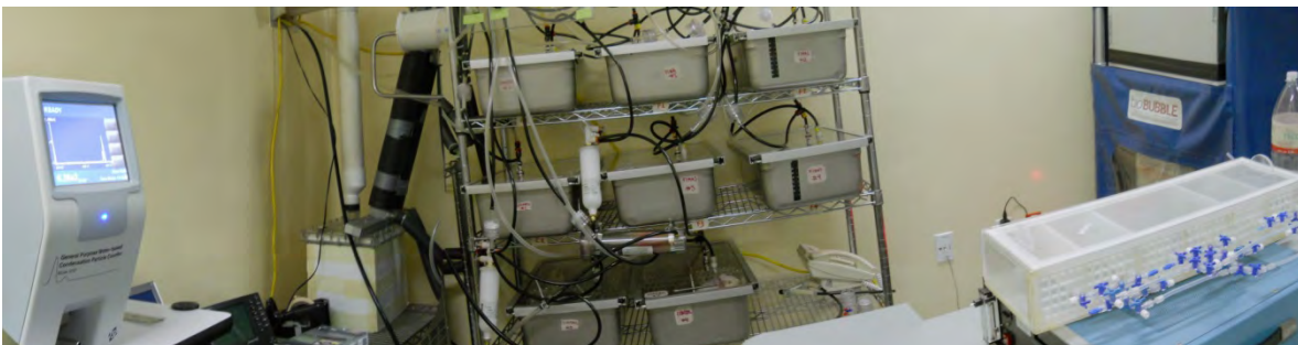
Figura 5. Sistema Concentrador de Partículas y cámaras de exposición para los cobayos.
