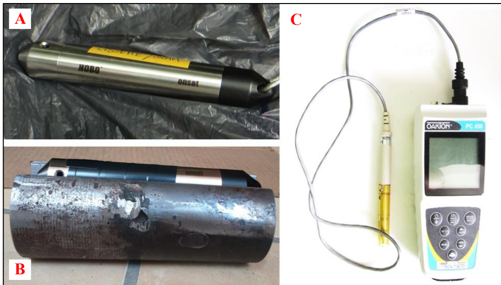
Figura 8. (A) Barómetro instalado; (B) Limnígrafo instalado con contrapeso; (C) Multiparamétrico.
