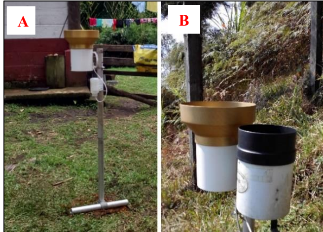
Figura 5. (A) Pluviómetro en la parte media-baja de la cuenca (1600 m); (B) Pluviómetros instalados en la parte media-alta (2100 m).
