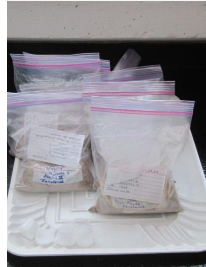
Figura 87. Izquierda, perfil de donde se extrajeron las muestras M1 y M2. A la derecha muestras de sedimentos analizados por petrografía y Fluorescencia de Rayos X
