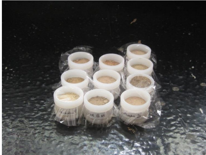
Figura 91. Cilindros de plástico que contienen las muestras molidas, etiquetados y cubiertos con película de prolipropileno listos para su análisis
