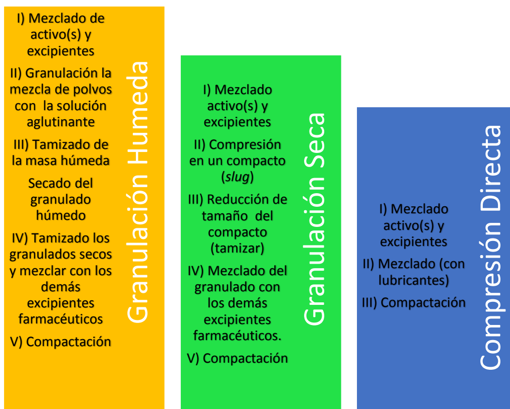
Figura 3.-Proceso de manufactura de comprimidos
