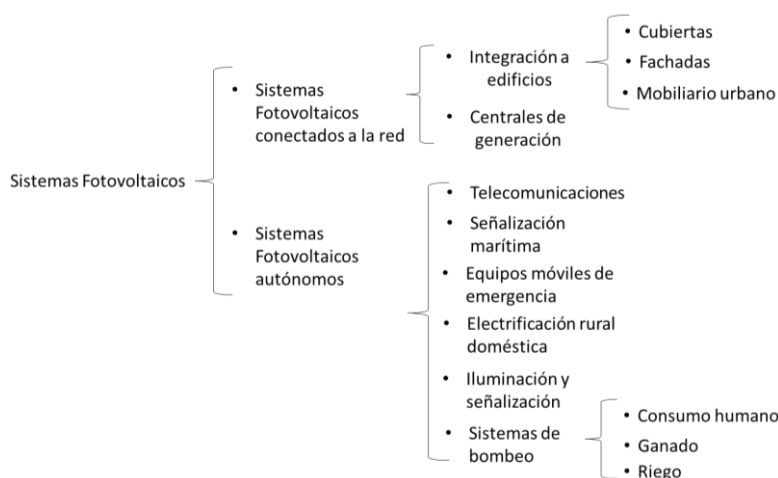
Figura 2.7 Clasificación de aplicaciones fotovoltaicas. Elaboración propia, 2016.
