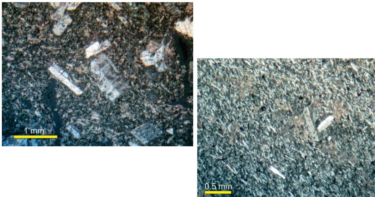
**Figura 5.4** Micrografías de muestras pertenecientes a la Formación Diquiyú, con fenocristales de plagioclasa y matriz microlítica de feldespato y óxidos. En ambas muestras se observan las plagioclasas alteradas a arcillas y calcita. Del lado izquierdo se muestra una textura porfídica, mientras que a la derecha se observa la foliación magmática.
