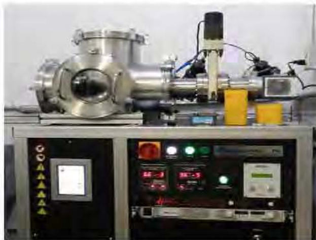
Figura 24. Equipo de Sputtering empleado para el depósito de las capas semillas.
