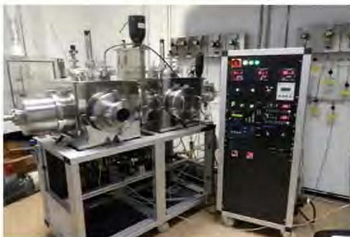
Figura 29. Equipo de PECVD empleado para la realización de los tratamientos de plasma.
