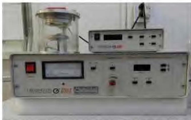
Figura 25. Equipo de Sputtering DC para el depósito del catalizador.
