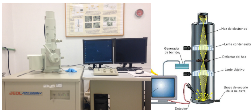
Figura 23. Microscopio Electrónico de Barrido JEOL JSM-6060LV y diagrama de funcionamiento.
