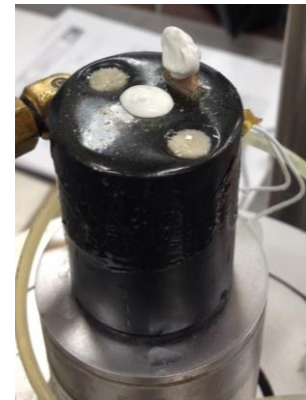
Figura 25 Mezcla de caolín para hacer contacto cristales-suelo
