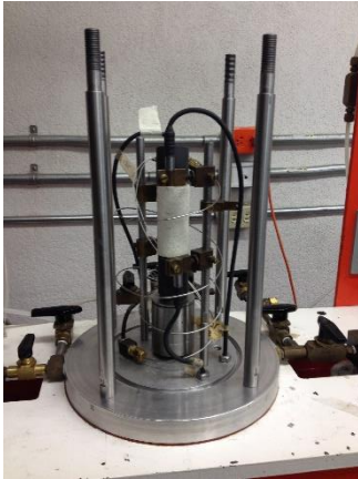
Figura 9 Vista de transductores de cámara triaxial neumática
