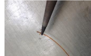
Figura 17 Extracción de núcleo de alambre de cobre galvanizado
