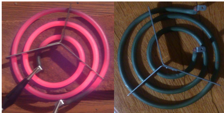
Imagen 7. Resistencia eléctrica de AC encendida (izquierda) y apagada (derecha)
