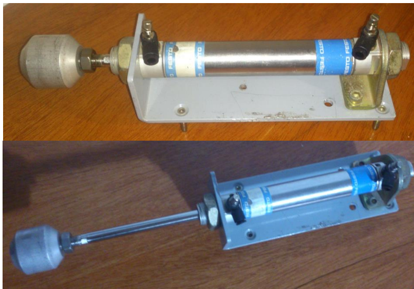
Imagen 9. Pistón de doble efecto con vástago dentro (arriba) y fuera (abajo).
