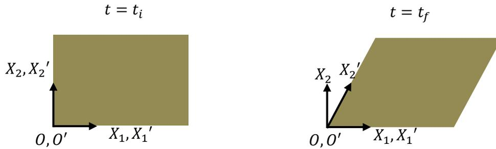
Figura 5.2 Esquema de movimiento de una placa deformable. Los ejes coordenados  $O'X_1'$  y  $O'X_2'$  están fijos a la placa.
