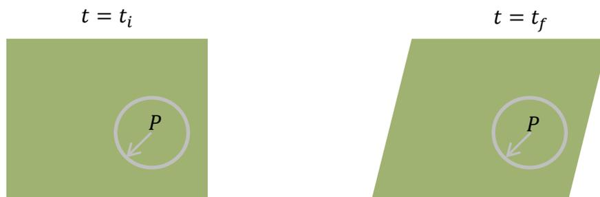
Figura 5.4 Vecindad alrededor de una partícula  $P$  de un sólido deformable, en la configuración inicial  $t = t_i$  y en la configuración final  $t = t_f$ .
