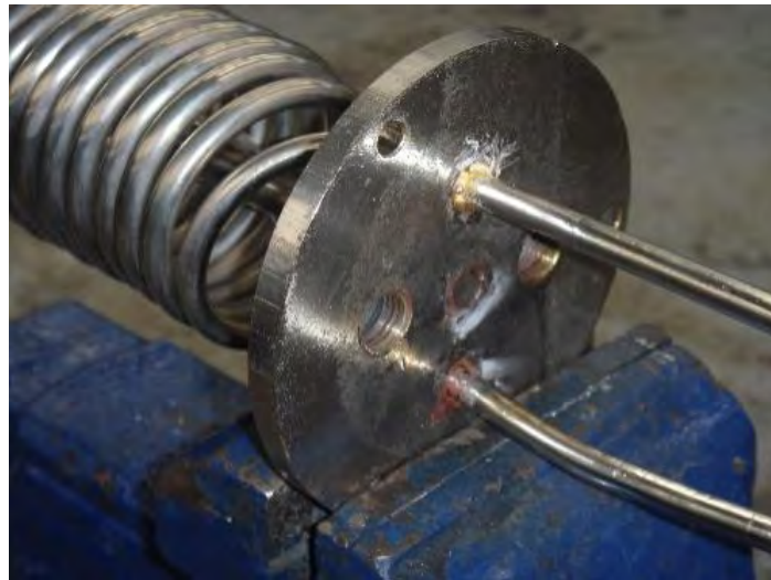
Figura 15 Tapa superior con el serpentín soldado.
