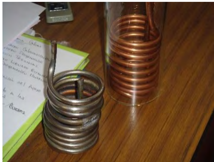
Figura 13 Serpentín original de color gris y serpentín de repuesto de cobre.
