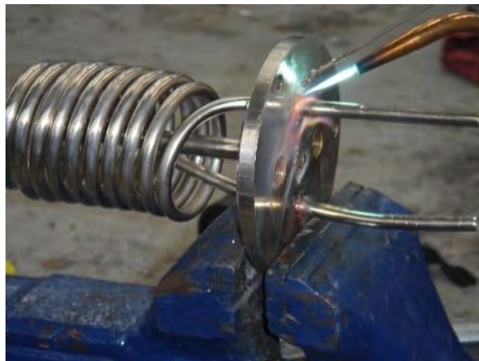
Figura 14 Se suelda el serpentín en la tapa superior empleando oxycetileno.
