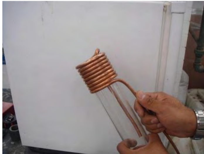
Figura 12 Tubo de cobre enrollado sobre el tubo deacrílico.
