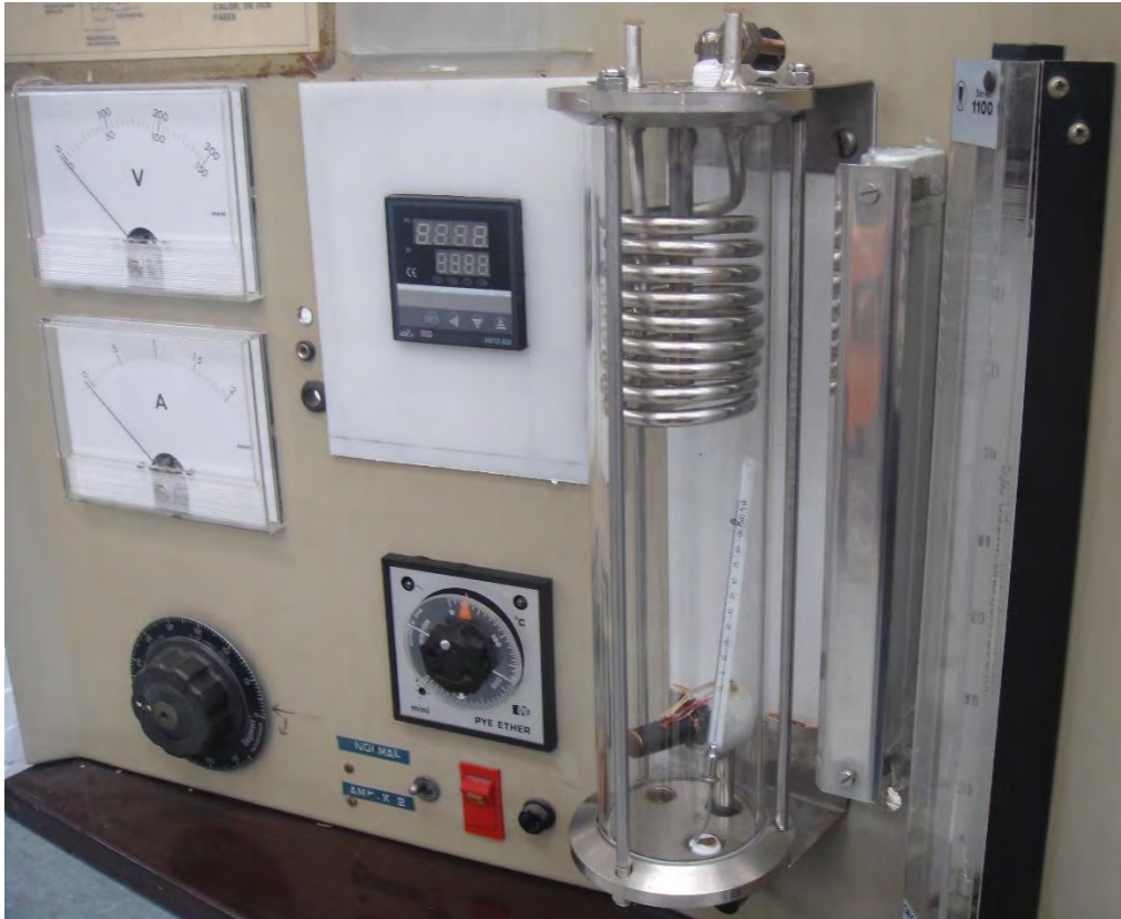
Figura 7 Intercambiador de calor ubicado en la Fes Aragón.
