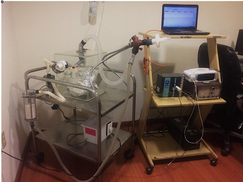
**Figura 3:** Sistema construido. Del lado izquierdo el circuito cerrado para re-respiración, del lado derecho los recursos para colección y procesamiento de señales.
