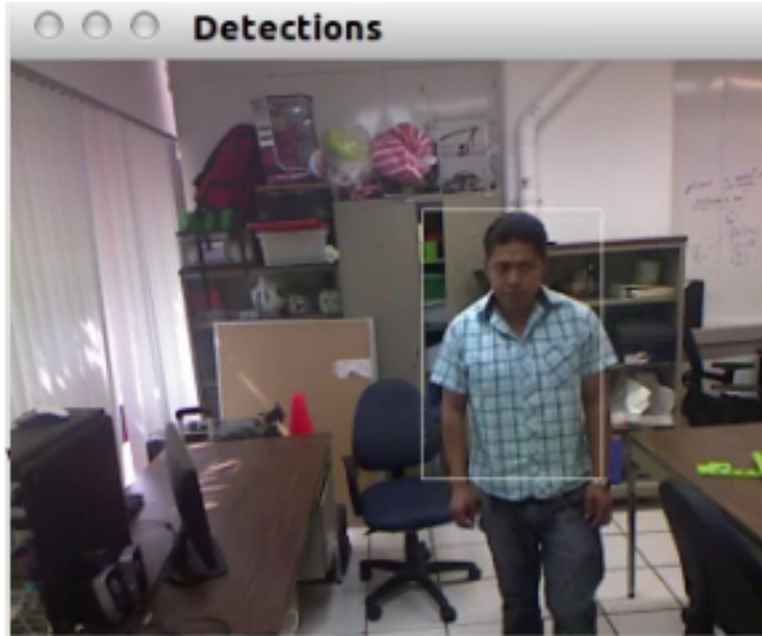
Figura 5.2.3: Región de interés del cluster detectado como posible persona
