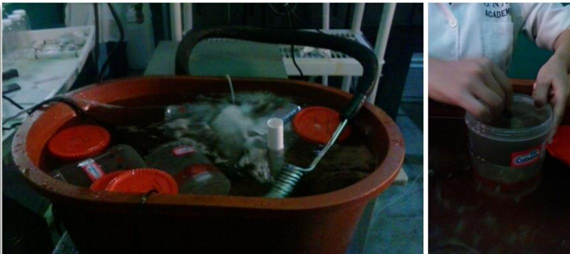
**Figura 11.** a) Sistema para llevar a cabo método TIMR max y min, b) medición de consumo de oxígeno.
