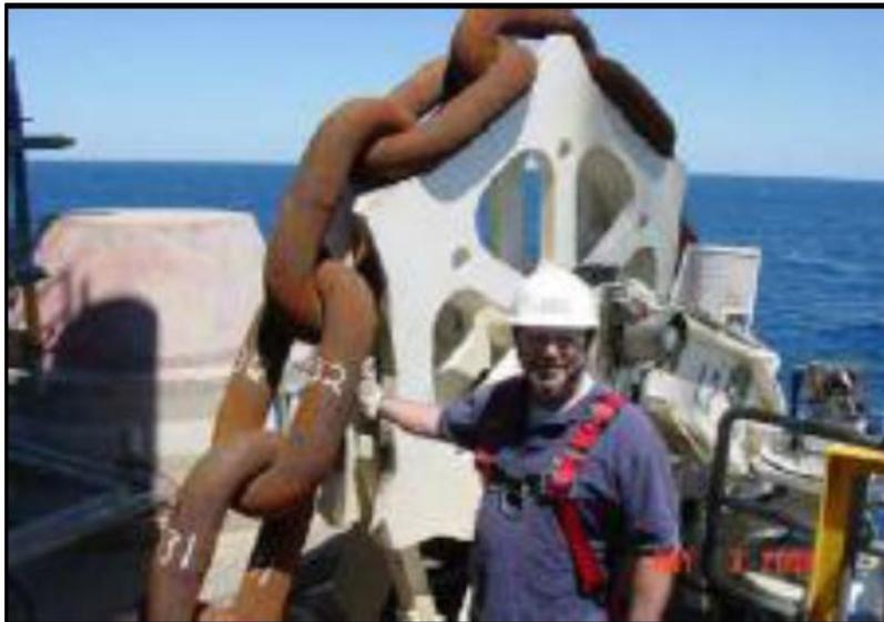
Figura 4.3. Tipo de cadena utilizada para el anclaje de plataformas marinas (Tomado de Sánchez Casas, 2012).
