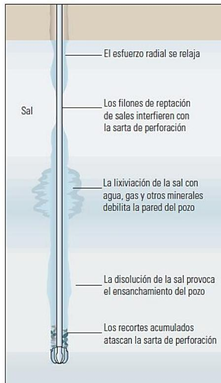
Figura 4.10. Problemas provocados por la mala selección de un fluido de perforación en sección salina (Tomado de Aburto Pérez, et al., 2009).
