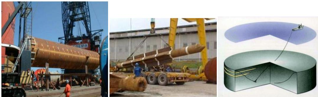
Figura 4.5. a) Pilotes de succión b) Pilotes torpedo c) Anclas de arrastre (Tomado de IMP, 2010).
