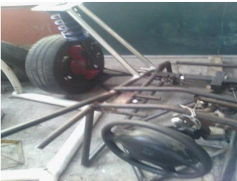
3.4.8 Centraje de horquilla, llanta-rin-amortiguador
