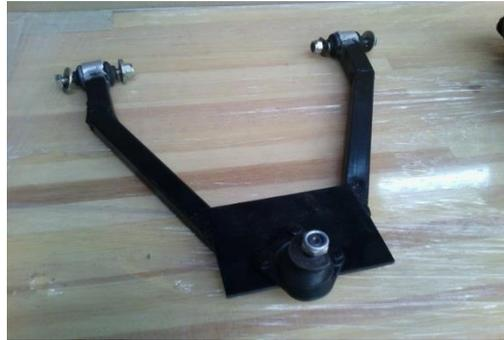
2.6.1 horquilla inferior con base para amortiguador
