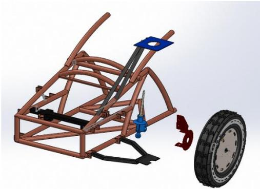
2.7.5 Diseño y ensamble de la suspensión
