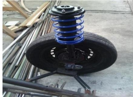
3.3.4 Conjunto resorte amortiguador acoplado al chasis
