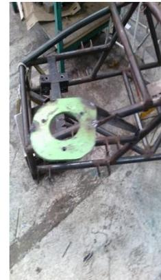
Esta placa de cedula 40 fue barrenada en el centro la cual tiene un diámetro de 9 cm y los tres barrenos que llevan atornillados permitirán ajustar el conjunto masa/resorte amortiguador al chasis de nuestro vehículo el cual va a ser a un único Angulo ya alineado para la llanta, este diseño va de esta forma debido a que la configuración de la suspensión MacPherson forma un triángulo articulado
