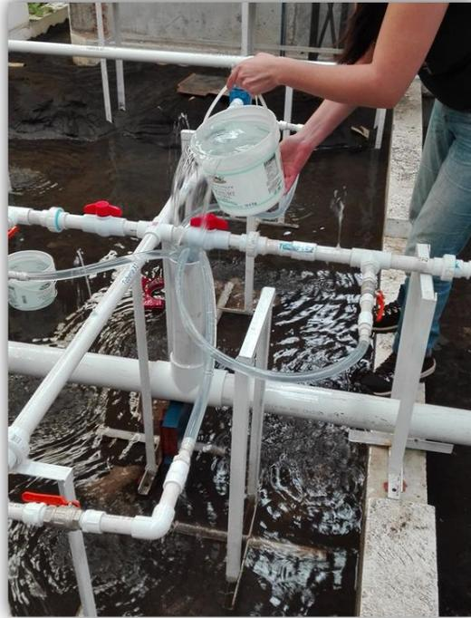
Fotografía 5, Primeras pruebas (Medición del gasto).
