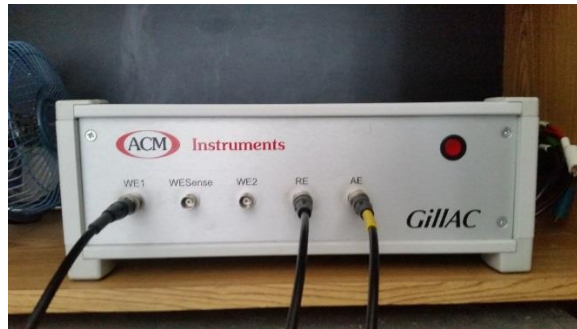
Fig. 33 Potenciostato marca ACM Instruments que se utilizó para hacer las mediciones.
