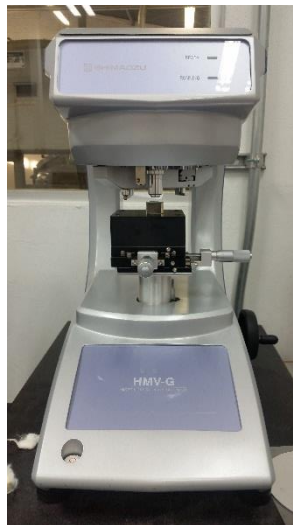
Fig. 32 Microdurómetro de la marca HMV-G del Instituto de Investigaciones en Materiales de la UNAM
