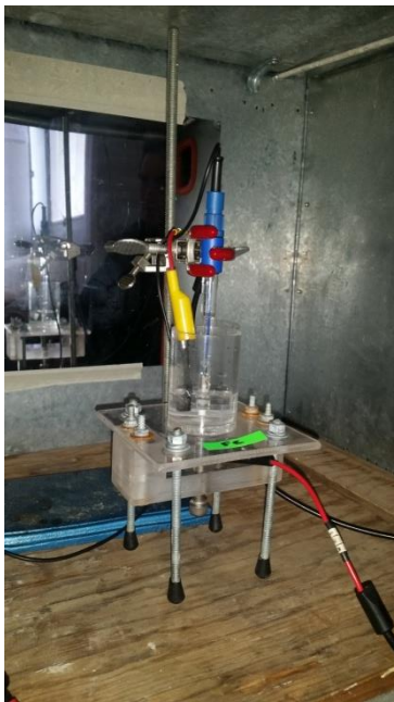
Fig. 35 celdas de corrosión montadas para la prueba IES.
