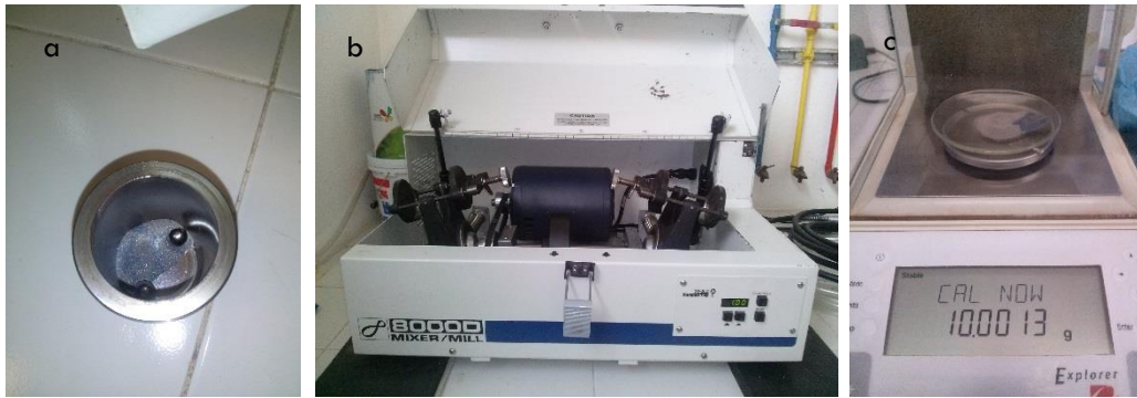
Fig. 21 Equipos y dispositivos utilizados para mezcla de polvos, (a) Diámetro de bola, (b) Dispositivo para las mezclas, (c) Bascula para medir el porcentaje de polvos.
