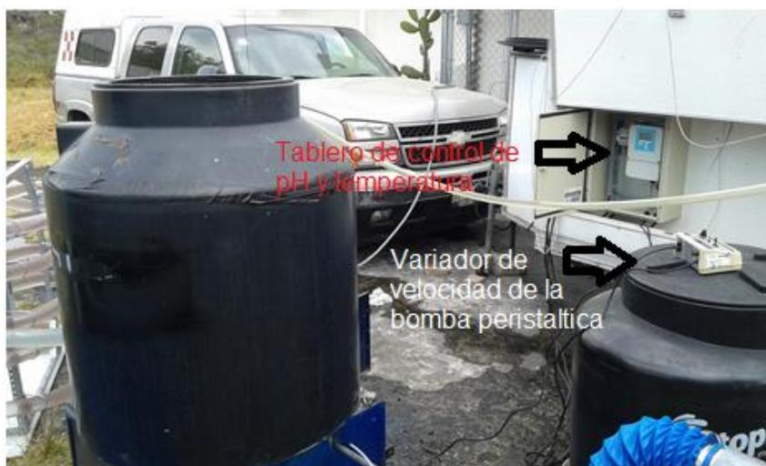
Figura 22 Sistema de control de pH.
