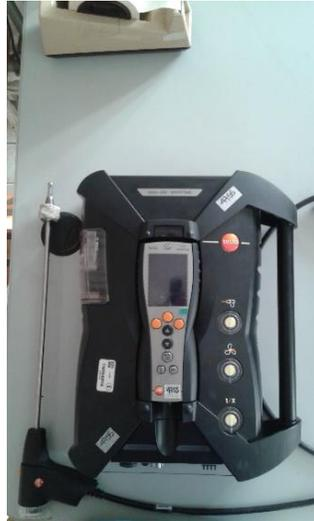
Figura 23 Medidor de concentración de gases Testo 350 Maritime.
