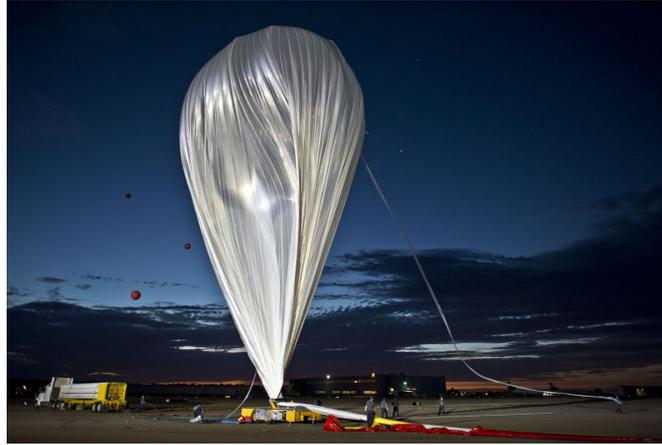
Figura 1.1: Proceso de inflado de un globo estratosférico [2].
