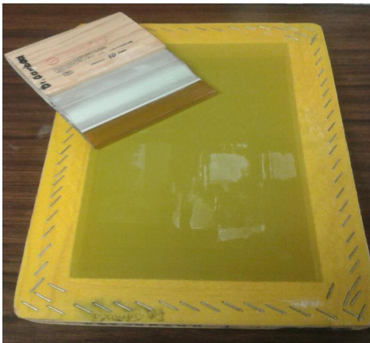
*Figura 30.* Malla y el rasante utilizado para la formación de película, la malla consta de 90 hilos por cm<sup>2</sup>.
