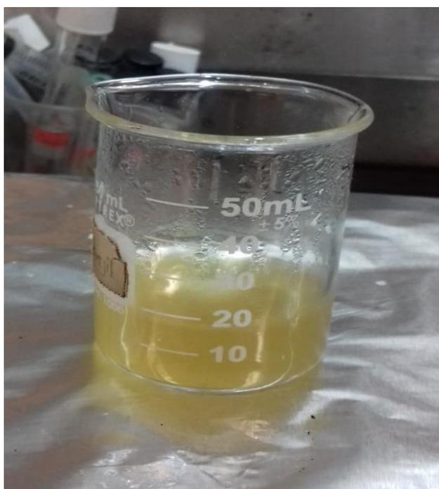
**Figura 21.** Cambio de color de la infusión indicando visualmente la síntesis de  $\text{ZnO}$ .
