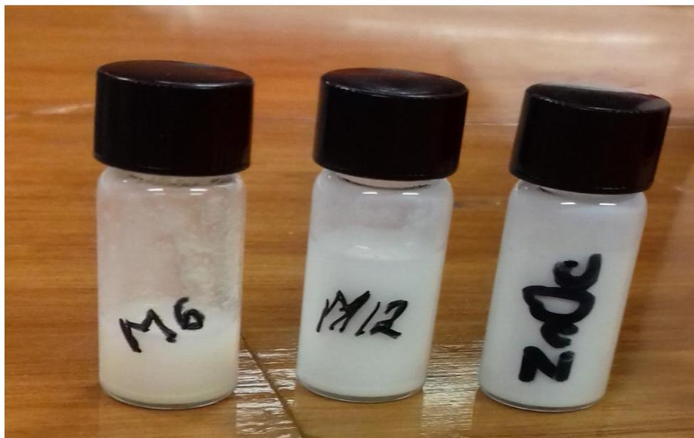
**Figura 29.** Pastas obtenidas para la elaboración de la película por la técnica de serigrafía. M6 corresponde al  $ZnO_{(p)}$ , M12 al  $ZnO_{(a)}$  y ZnOc al  $ZnO_{(c)}$ .
