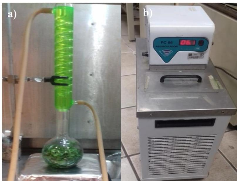
**Figura 19.** a) Condensador tipo serpentín, b) Recirculador FC 06.
