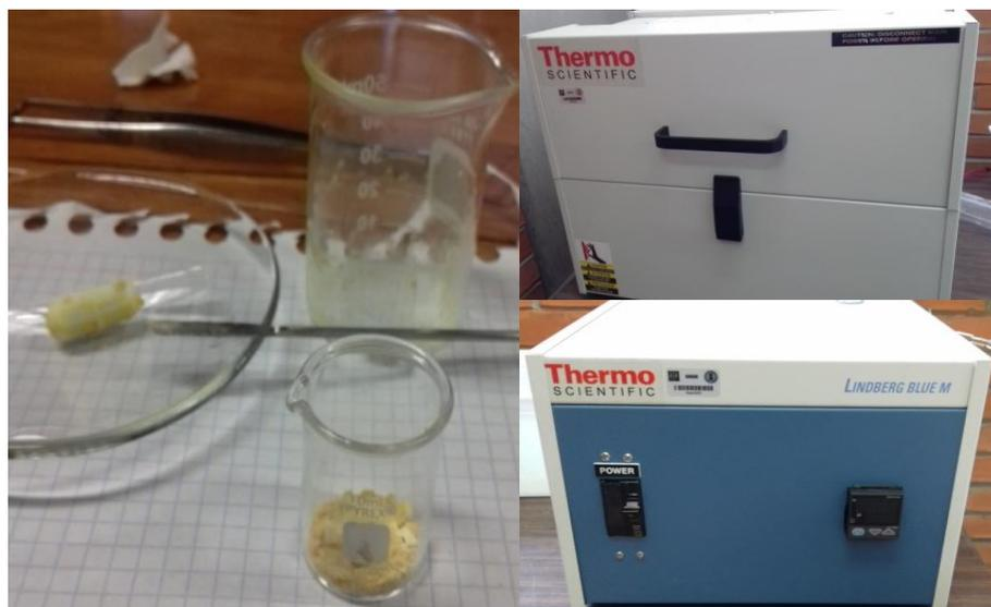
**Figura 26.** a) El material que sería sometido a tratamiento térmico. b) Equipo THERMO SCIENTIFIC LINDERBERDG BLUE M que se empleó para dicho tratamiento.
