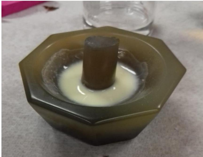
**Figura 28.** Solución de  $ZnO_{(p)}$  con  $CH_2CH_3$  (Etilcelulosa) y  $C_{10}H_{18}O$  (Terpineol).
